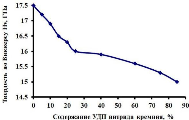
Рисунок 153 – Зависимость твердости по Виккерсу образцов от количества УДП Si<sub>3</sub>N<sub>4</sub>
