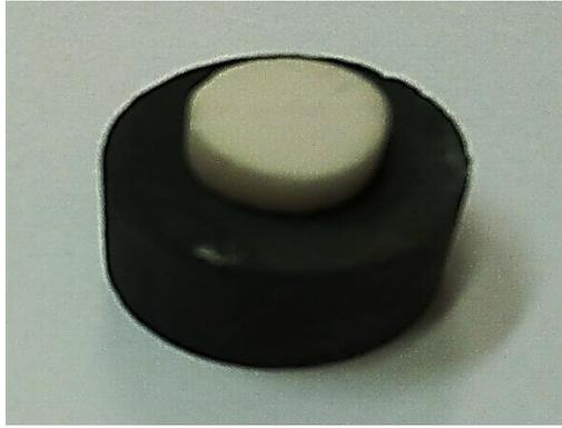
Рисунок 44 – Образцы SiC–MeO для изучения смачивания
