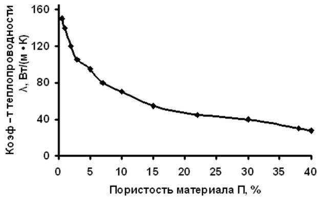
Рисунок 176 – Зависимость коэффициента теплопроводности при температуре 25°C от пористости SiSiC-материалов
