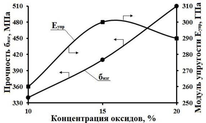
Рисунок 143 – Зависимости модуля упругости и прочности при изгибе SSN-материалов от количества оксидов (составы 1–3)
