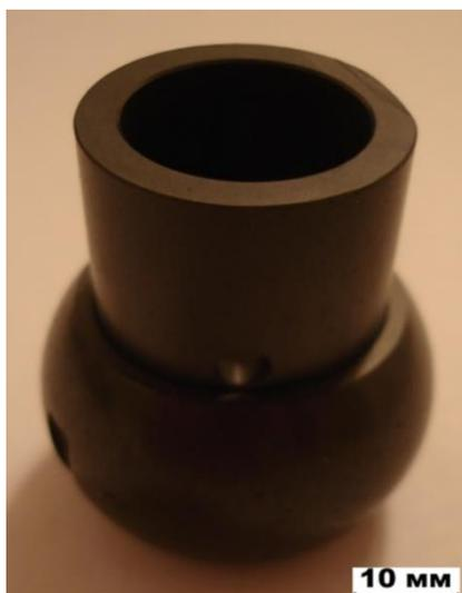
Рисунок 193 – Подшипниковый узел (вкладыш–втулка)
