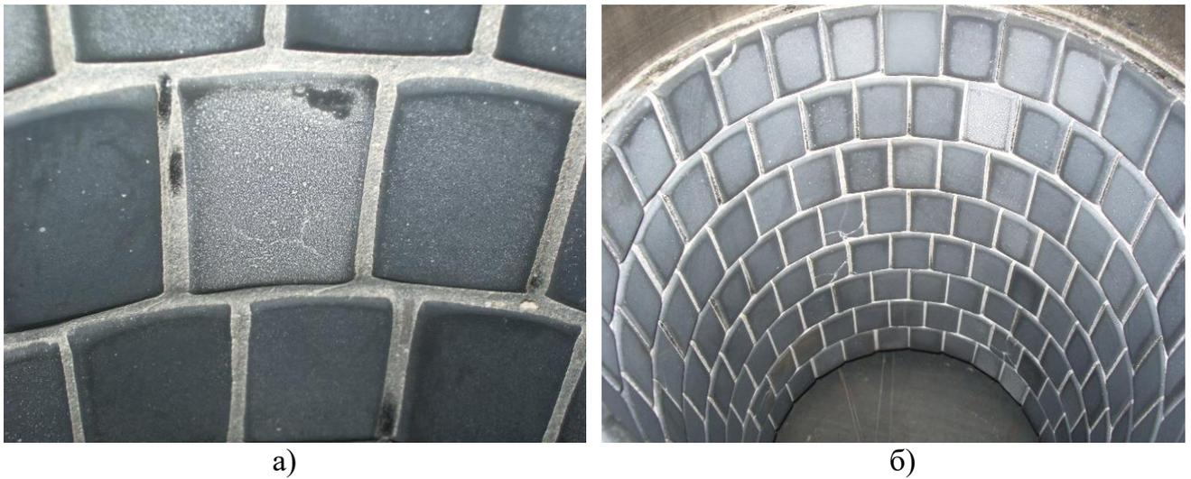
Рисунок 195 – Футеровка керамическими плитками барабана планетарной мельницы. Увеличение 1,5\* (а); 0,3\* (б)
